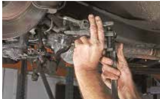
Kugelkopfausdrücker sind nicht teuer und leisten gute Dienste. Meistens... In unserem Fall brachte er allerdings schon beim Kugelkopf des Lenkhebels nicht genug Kraft auf, weshalb die Mutter wieder...
