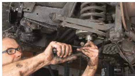
Nie ohne! Mit einem Profi-Federspanner komprimiert Peter Dwinger die Feder bis kein Druck mehr...
