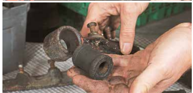
Noch gar nicht mal so schlecht: Etwa fünf Jahre als waren die Gummibuchse der Achse, die uns als Fotomodell diente
