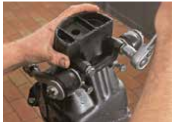
Die Polyurethanbuchse werden mit ein wenig speziellem Fett, dass ihnen beiliegt montiert
