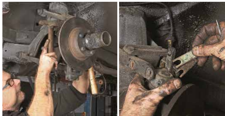
...dann kommen wieder der Ausdrücker oder die beiden Hämmer zum Einsatz. Alternativ kann man das obere Trag- gelenk nach Lösen zweier Schrauben auch vorerst am Achsschenkel belassen. Und schön aufpassen: Wieviele Distanzscheiben saßen wo?
