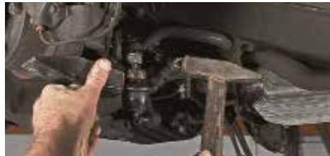
...wenige (!) Umdrehungen aufgeschraubt wurde und zwei Hämmer erfolgreich zum Einsatz kamen
