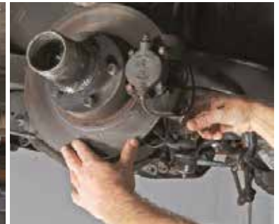
Kugelkopfausdrücker sind nicht teuer und leisten gute Dienste. Meistens... In unserem Fall brachte er allerdings schon beim Kugelkopf des Lenkhebels nicht genug Kraft auf, weshalb die Mutter wieder...
