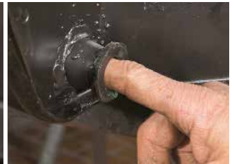
Fett fertig zum Einbau: die Lagerbrücke des oberen Querlenkers. Nur die Farbe von der Anlagefläche muss noch runter!
