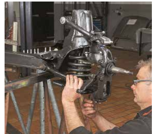
Der Achsträger kurz vorm Feierabendbier. Im Federdomstz oben die im Kasten auf Seite 19 gezeigte Unterlegplatte. Was noch fehlt sind Radlager & Co.
