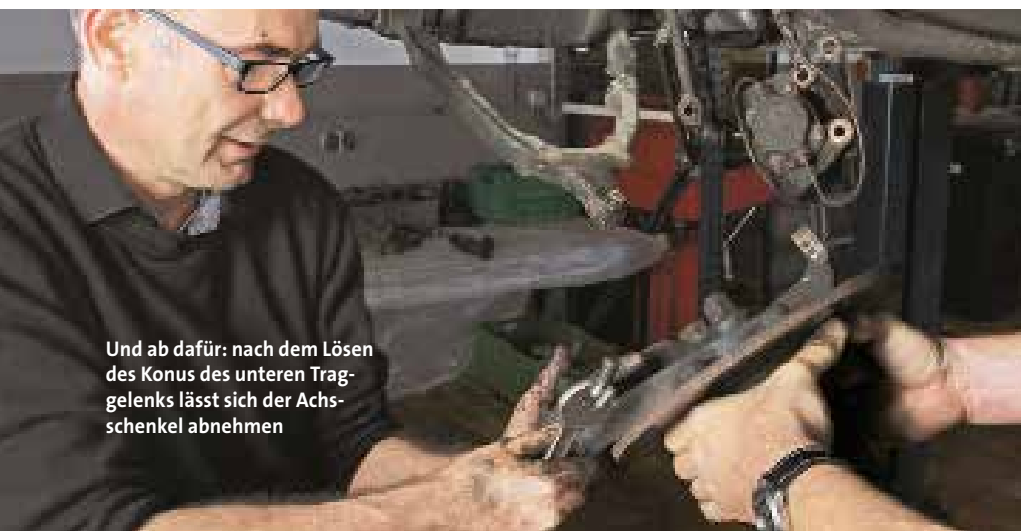
...dann kommen wieder der Ausdrücker oder die beiden Hämmer zum Einsatz. Alternativ kann man das obere Trag- gelenk nach Lösen zweier Schrauben auch vorerst am Achsschenkel belassen. Und schön aufpassen: Wieviele Distanzscheiben saßen wo?
