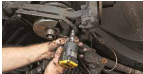
...auf dem unteren Federteller lastet, dann kann er letzteren vom Querlenker abschrauben
