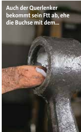
...uns schon bekannten „Spezialwerkzeug“ eingedrückt wird
