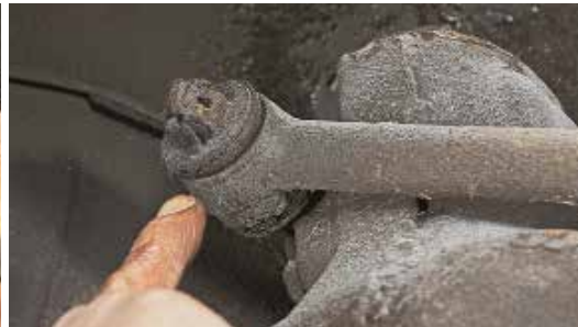
Das untere Traggelenk ist eines der üblichen Verschleißteile
