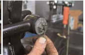
Die Lagerbrücke ist beim Mk2 auf der Rückseite des Achsträgers verschraubt – mit zwischengelegten Distanzblechen zur Sturzeinstellung. Es gilt: Immer die vorgefundene Zahl (wenn sie nicht offensichtlich unplausibel ist) einsetzen. Vor der Endmontage werden Hohlräume konserviert, die Querlenkerbolzen dann eher stramm verschraubt
