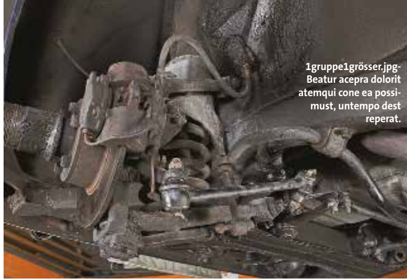
Wenns an der Achse rumpelt und poltert stehen alle Querlenker- Gummibuchsen unter Generalverdacht
