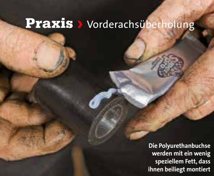
Auch der Querlenker bekommt sein Fett ab, ehe die Buchse mit dem...
