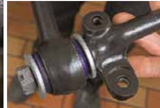
Fett fertig zum Einbau: die Lagerbrücke des oberen Querlenkers. Nur die Farbe von der Anlagefläche muss noch runter!
