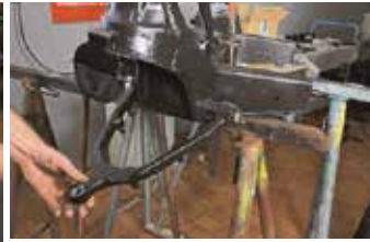
Die Lagerbrücke ist beim Mk2 auf der Rückseite des Achsträgers verschraubt – mit zwischengelegten Distanzblechen zur Sturzeinstellung. Es gilt: Immer die vorgefundene Zahl (wenn sie nicht offensichtlich unplausibel ist) einsetzen. Vor der Endmontage werden Hohlräume konserviert, die Querlenkerbolzen dann eher stramm verschraubt
